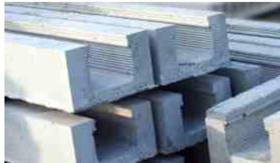
Предварительно напряженные детали ригелей для сборномонолитных каркасов зданий, армированные высокопрочной проволокой класса ВР1400. Расчетная нагрузка на сборномонолитный ригель 6,0-8,0 тс/п.м для которого предназначена деталь ригеля.
