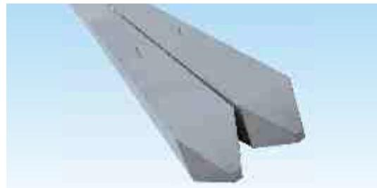
Сваи составные квадратного сечения 300x300 с ненапрягаемой арматурой состоят из двух свай : верхней и нижней, соединение свай производится сварным стыком .
