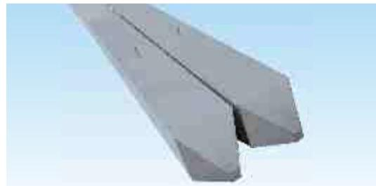
Сваи составные квадратного сечения 350x350 с ненапрягаемой арматурой состоят из двух свай : верхней и нижней, соединение свай производится сварным стыком .
