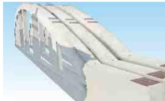
Балки предназначены для покрытий зданий с шагом стропильных конструкций 6 м с фонарями и без фонарей, с подвесным подъемно-транспортным оборудованием г/п до 5 т. и без него. Для неагрессивной среды
