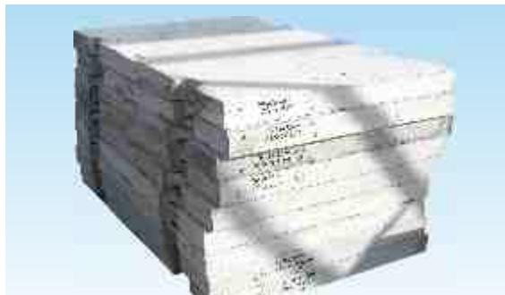
Железобетонные дорожные плиты с ненапрягаемой арматурой размерами 2,0x3,0 м и предварительно напрягаемой арматурой 2,0x6,0 для устройства сборочных покрытий постоянных и временных дорог под автомобильную нагрузку Н-30 тн и Н-10 тн
